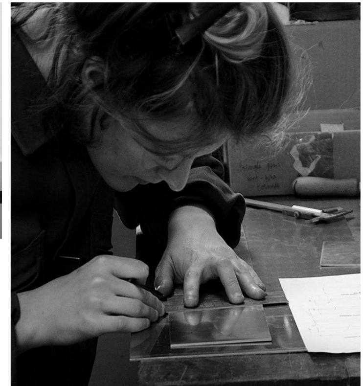
Tracé avant réalisation d'une monture, en bronze sur les établis de l'atelier, 2020
